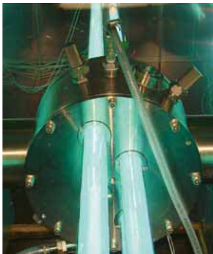
Pilotreactor bij KWR Watercycle Research Institute (hierin kunnen zowel LD, MD- als DBD-lampen worden toegepast).
